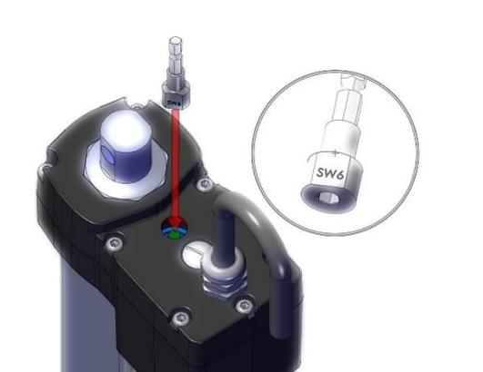
Mise en place d'une clé à douille commerciale (douille de 6 mm)
